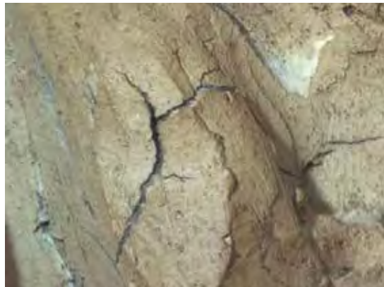
Krimpscheur in de mantel © KIK-IRPA, Brussel
